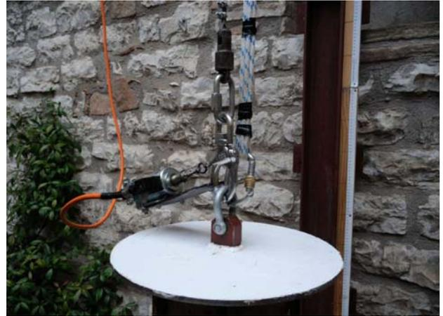
*Particolari della torre di caduta: cella di carico, misuratore laser (a sinistra) e sistema di sgancio del peso (sopra)*
